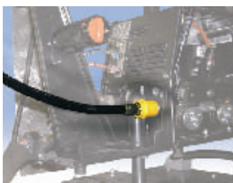
L'installazione è semplice e veloce come mostrato qui sopra per Mini Marathon Pac. La guaina del filo è collegato ai connettori rapidi sull'attacco guidafile (indicato qui sopra con una croce) e sull'alimentatore del filo.
