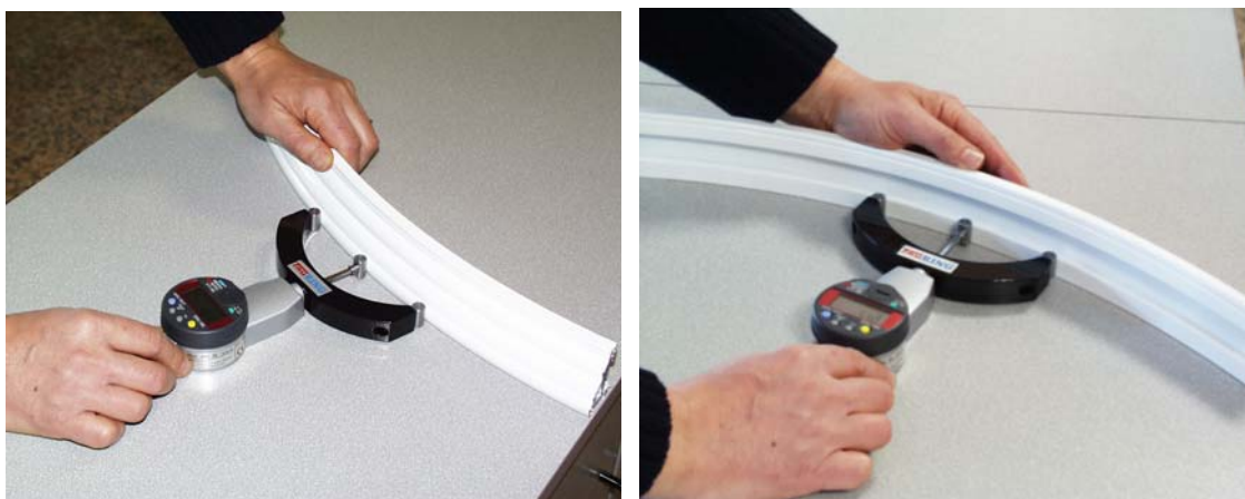
Misurazione di raggi esterni ed interni con l'archimetro ARC 50/130
